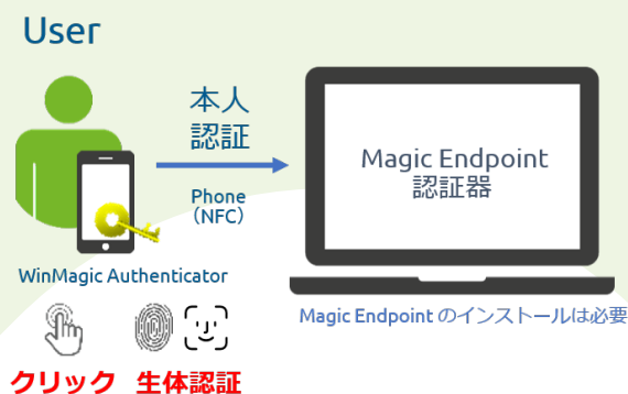
図4 PIN入力や生体認証のほか、スマートフォンアプリを用いた本人認証も可能
