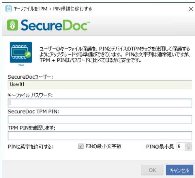
[キーファイルパスワード:] 欄には、プリブート認証でこれまで使用していたパスワードを入力し、[SecureDoc TPM PIN:] 欄に、画面に下に表示されているルールにそって PIN を入力します。[TPM PIN を確認します:] 欄は、確認のためのものなので、同じ PIN を入力し、<OK> をクリックします。
